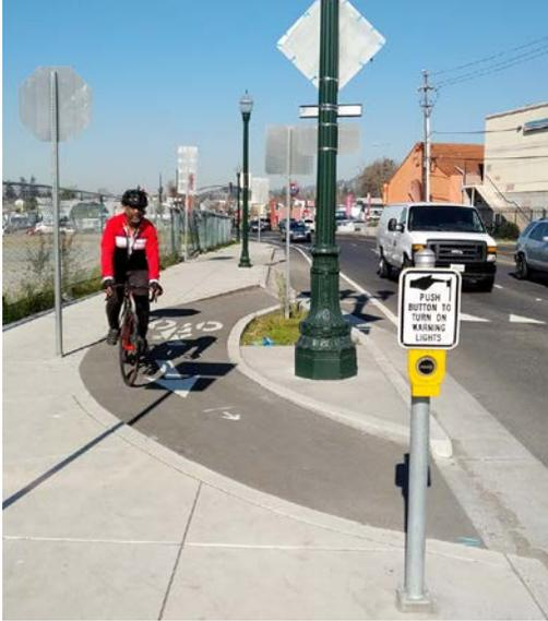
新特色包括在 Richards Rd 路口劃設自行車格，並裝設標誌以引導南行自行車前往 Seminary Ave 和 Millsmont，以改善此路口的穿越道。I-580 高架橋下北側的外延區大幅縮減了穿越道的距離，儘量減少與機動車輛發生衝突的可能性。本工程項目西端的路徑起點為半圓環設計，如此可讓自行車騎士與車流呈直角，提高來車駕駛人的能見度。鄰接的人行道經過拓寬，再加上一座中央安全島，使車道變窄並打造出一個便於通行的穿越道。按鈕式閃爍信號燈、尖齒形提前禮讓標記，以及對應的標誌，都能警告汽車駕駛人要禮讓行人和自行車。所有自行車穿越道都進一步以綠色衝突區/行人穿越道記號加以強調。未來將繼續實施的項目包括：鋪設下一段路徑 (Richards Rd 至 Seminary Ave) 和 Camden St 上的自行車道，打造一條通往 Bancroft Ave 和 Havenscourt Blvd 的連續自行車路徑。(面向西方的半圓環路徑設計；攝影：Robert Raburn)
