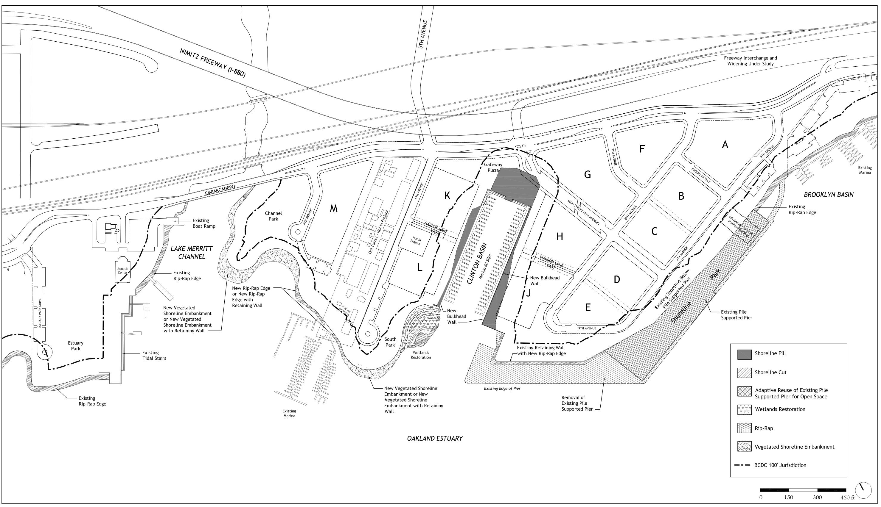
SHORELINE RECONFIGURATION AND STABILIZATION PLAN
