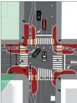
十字路口創新。6月下旬，美麗湖 BART 站周圍五個十字路口的行人安全改善工作已經完成。該工程項目安裝了彩繪燈泡、反光護柱，並完成信號的改變，以減少行人和車輛的衝突。在 Madison St / 8th St 和 Madison St / 9th St 路口採用具保護性的十字路口設計元素，更妥善地隔開自行車騎士和車輛的轉彎動作，並增加車輛對自行車的禮讓。該工程項目還延長了裝載區，讓接送行人的車輛能夠遠離公共汽車站和自行車道路。更多資訊請見 [www.oaklandca.gov/projects/lake-merritt-intersection-improvements](http://www.oaklandca.gov/projects/lake-merritt-intersection-improvements)。
