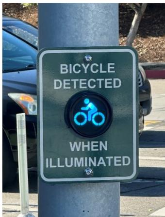
2. La luz del detector se ilumina cuando un ciclista espera en la intersección.
