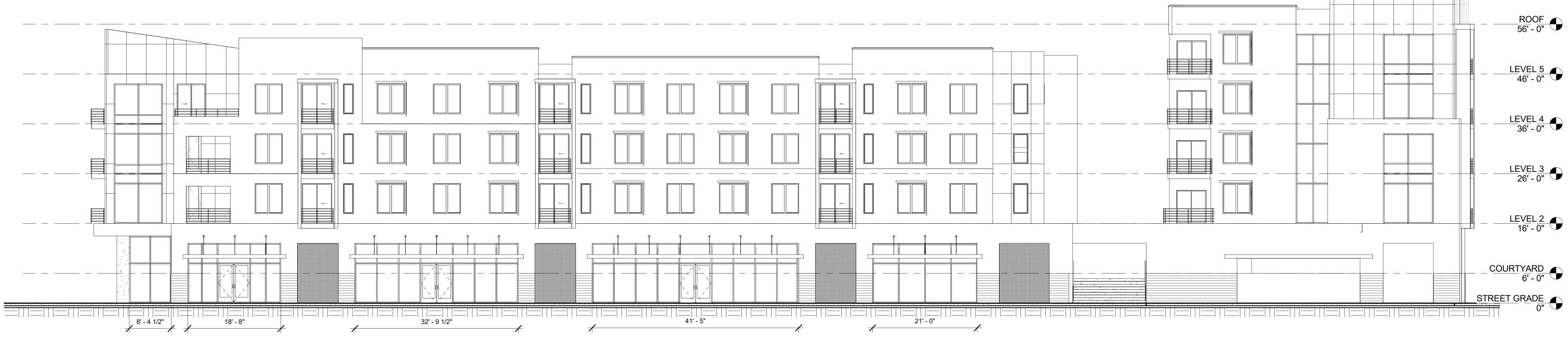
TOTAL STOREFRONT LENGTH ALONG COMMERCIAL PORTION - 122' - 3" TOTAL WALL LENGTH ALONG COMMERCIAL PORTION OF BUILDING - 191' - 8" % OF TRANSPARENCY (@ BOTH 2' AND 9') - 63.8%
