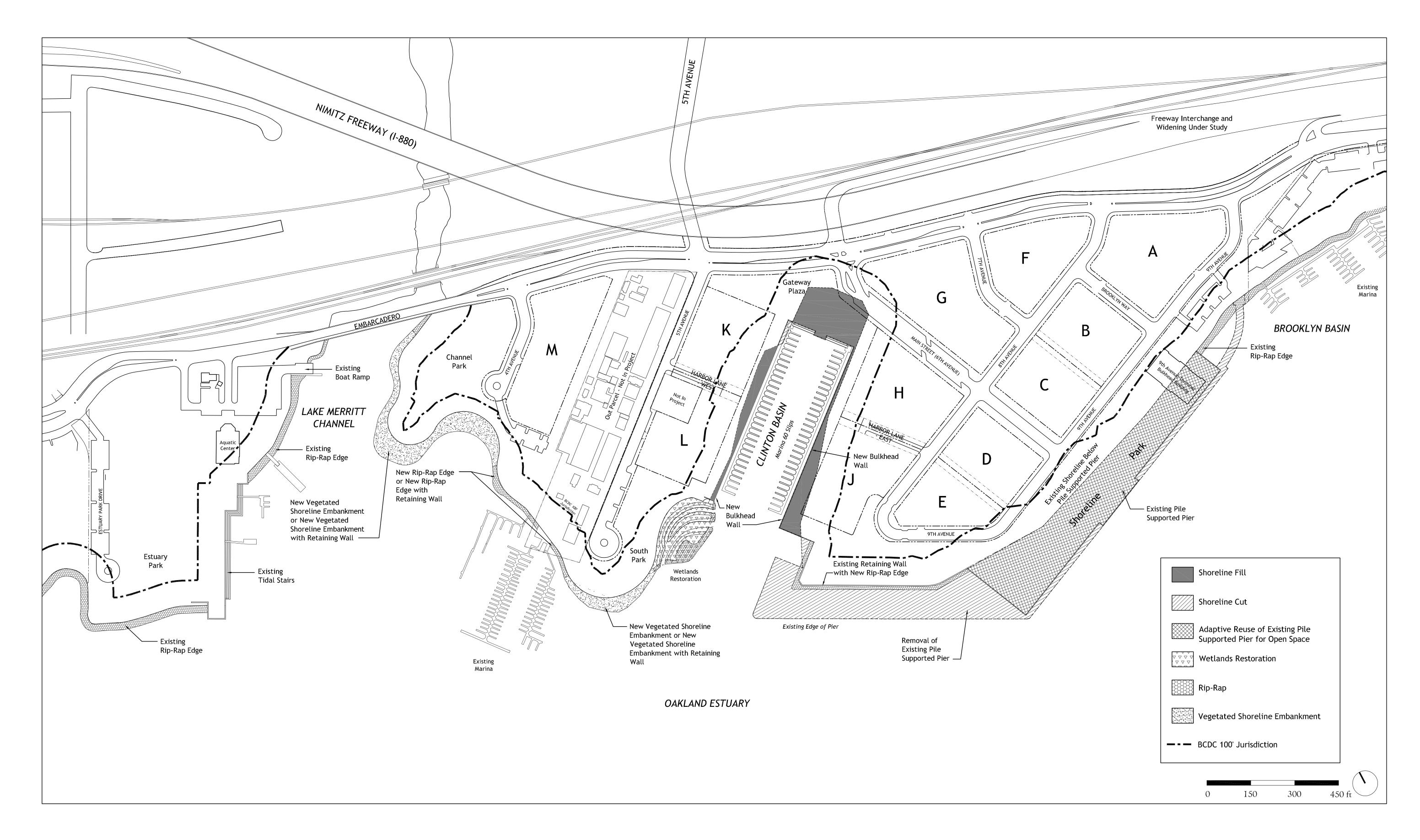
SHORELINE RECONFIGURATION AND STABILIZATION PLAN
